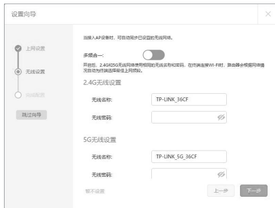
图4-8 多频合一开关关闭
