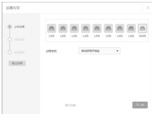
图4-6 上网方式-自动获取IP
